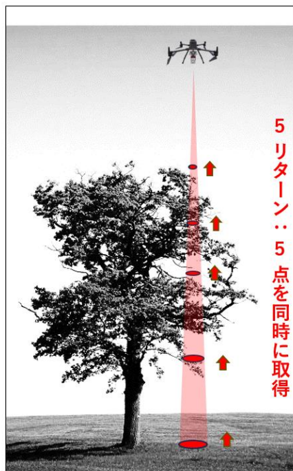
隙間を貫き地表面を検出
